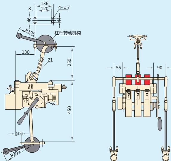
DW16-2000直接手柄操作及电动机操作外形及安装尺寸
